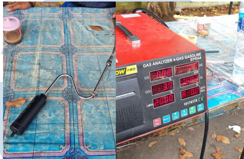
Gambar 3.6 Probe (kiri) & Gas Analyzer (Kanan) (Dokumentasi Pribadi)
