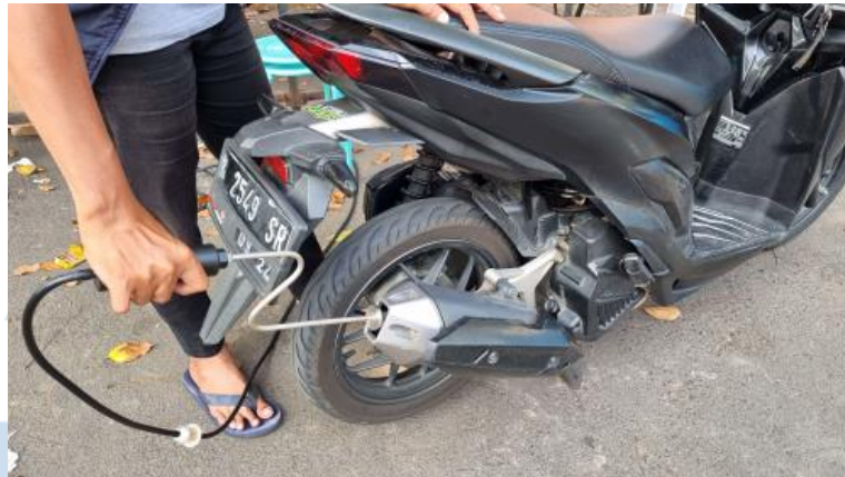
Gambar 3.7 Petugas Memasukkan Probe ke Dalam Lubang Knalpot (Dokumentasi Pribadi)
