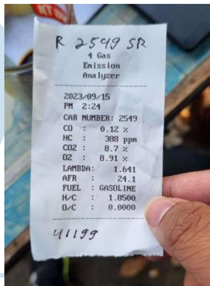
Gambar 3.8 Hasil Ukur Kandungan Asap Sepeda Motor Oleh Gas Analyzer
