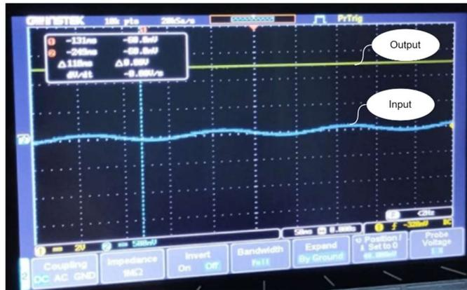
Gambar 3.12 Grafik Sinyal Output *Band pass filter* Subsistem *Elbow Sleeve* Pada Frekuensi 7 Hz dengan resolusi waktu 50ms/div, resolusi tegangan sinyal input (biru) sebesar 500mV/div dan sinyal output (kuning) sebesar 2V/div
