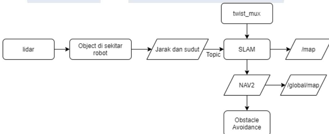
Gambar 2.7 - Konsep Sistem *Path Planning* Algoritma A\*
