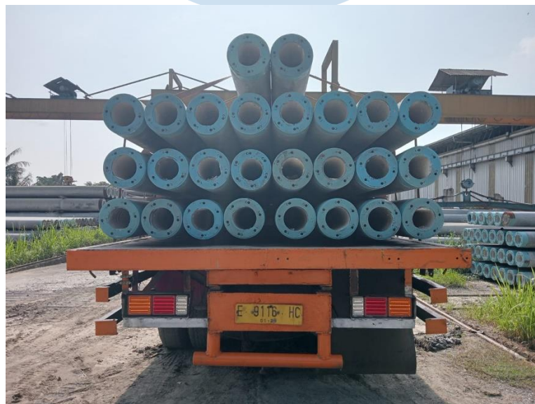
Gambar 3.6 Produk spun pile Sumber: (Dokumentasi penulis, 2024)
