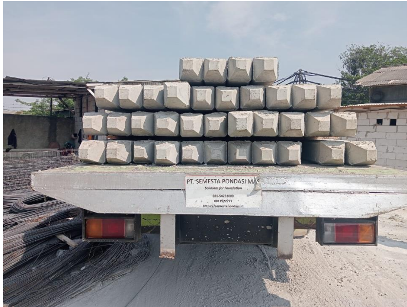
Gambar 3.5 Produk tiang pancang kotak Sumber: (Dokumentasi penulis, 2024)
