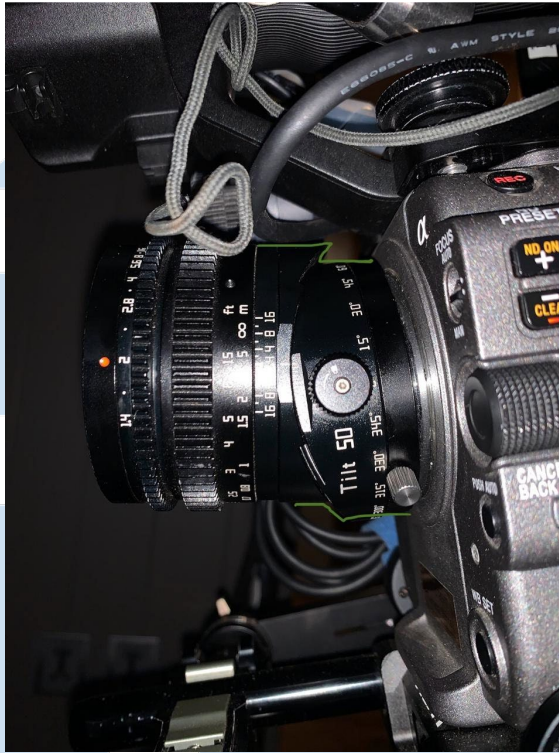
Gambar 3.2 Lensa tilt shift
