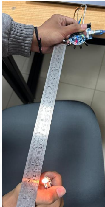
Gambar 3.8 Pengujian flame sensor dengan jarak 30 cm
