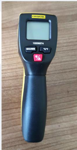
Gambar 3.16 - Termometer tembak inframerah (IR)
