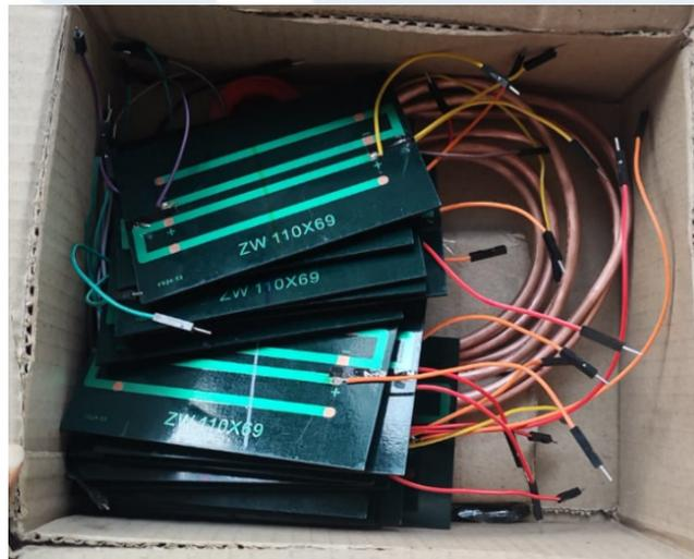
Gambar 3.22 - Sel surya setelah selesai proses solder
