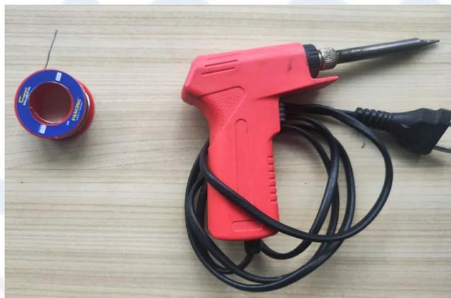
Gambar 3.10 - Timah solder (kiri) dan alat solder (kanan)
