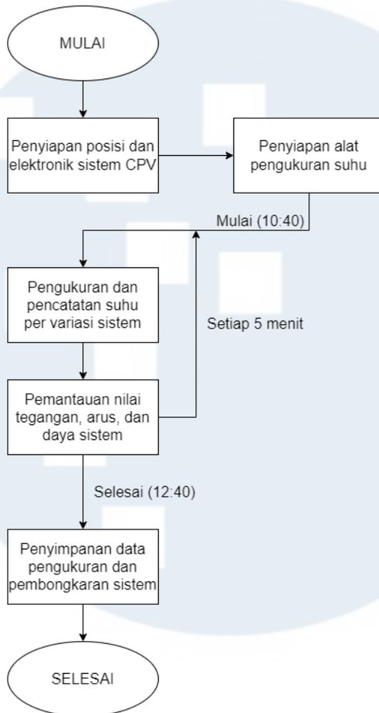
Gambar 3.26 - Diagram alur proses perolehan data sistem
