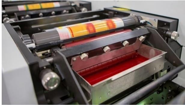
Gambar 2.18 Teknik Cetak *Flexography*
