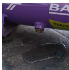
Step 3 Buang air kelembaban yang terjebak dalam tabung
