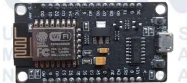
Gambar 2.2 NodeMCU ESP8266 (Dokumen Penulis)
