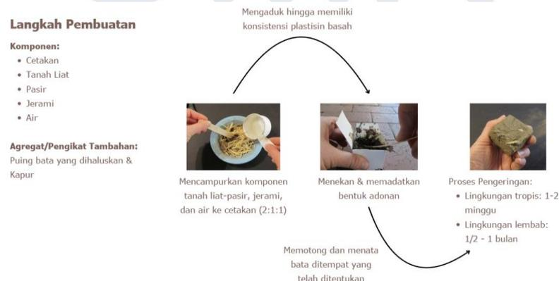
**Gambar 2.3 Langkah Pembuatan Tanah Adobe**
