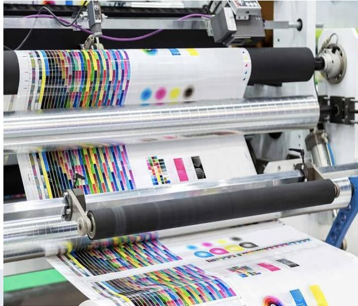
Gambar 2.57 Mesin cetak *offset*
