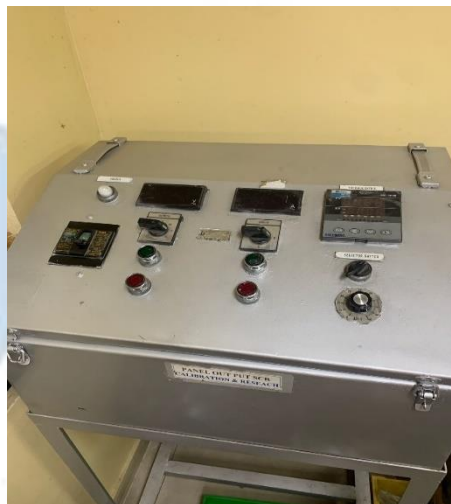
Gambar 3. 1 Panel Output SCR Sumber: Data Pribadi Penulis
