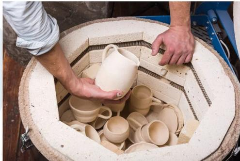
Gambar 2. 28 Mesin Kiln Pada Proses Pembuatan
