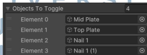
Gambar 3.15. Inspector Unity: konfigurasi daftar objek yang akan diaktifkan setelah pemasangan plank.
