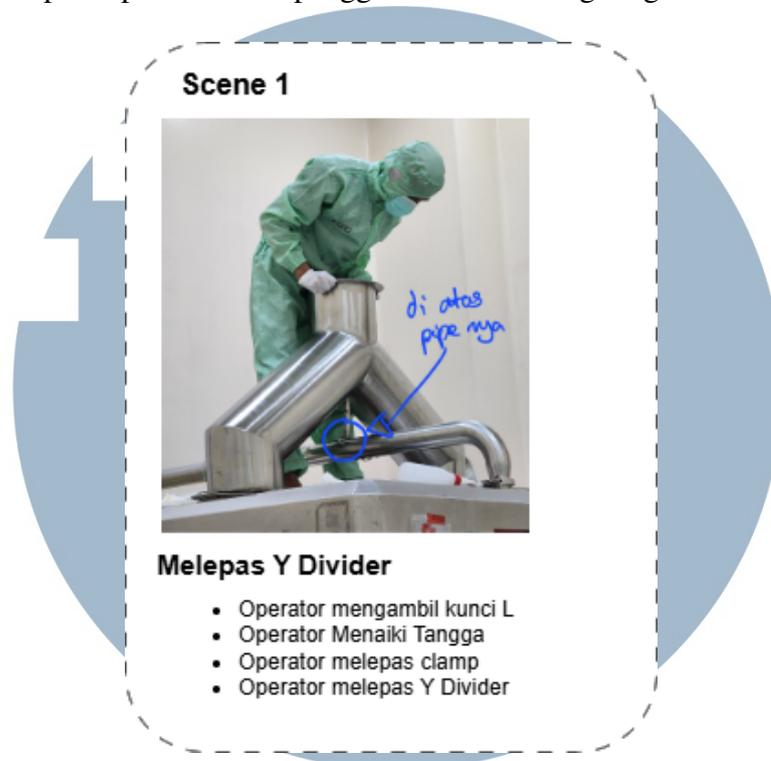
Gambar 3.11. Contoh storyboard skenario interaksi disassembly komponen.
