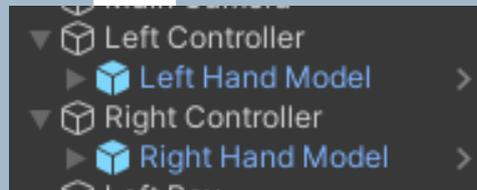
Gambar 3.30. Struktur hierarki XR Rig dengan penambahan model tangan sebagai anak dari kontroler kiri dan kanan.
