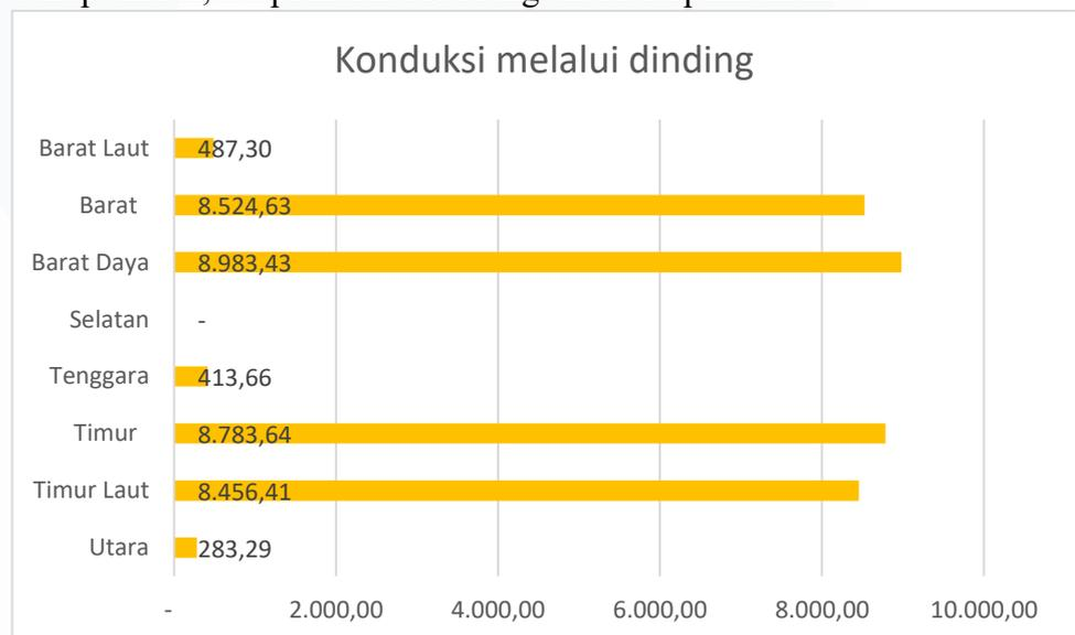
Gambar 3. 11 Tingkat perpindahan panas konduksi melalui dinding pada tiap orientasi.
