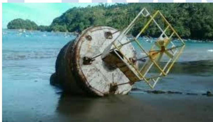
Gambar 1.4 Alat Tsunami Buoy yang rusak
