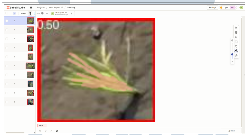
Gambar 3.9. Proses labelling materi model U-NET di Label Studio. Bagian yang berwarna merah muda adalah masking yang diberikan.
