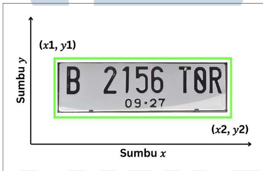
Gambar 3.8. Area deteksi plat nomor dengan *bounding-box*
