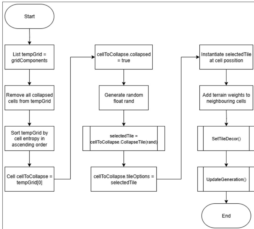
Gambar 3.9. Flowchart Modul *Collapse Cell*
