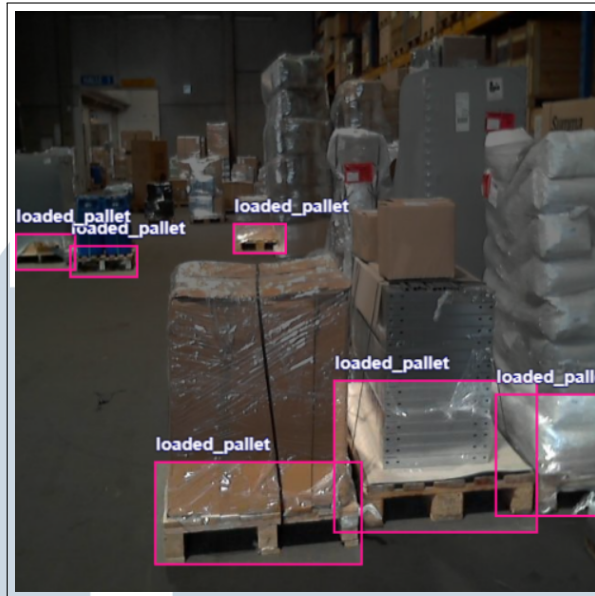
Gambar 3.4. Deteksi loaded_pallet pada pengujian lokal.
