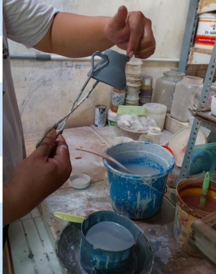
Gambar 3.3 Dokumentasi Simulasi Pengglasiran Keramik
