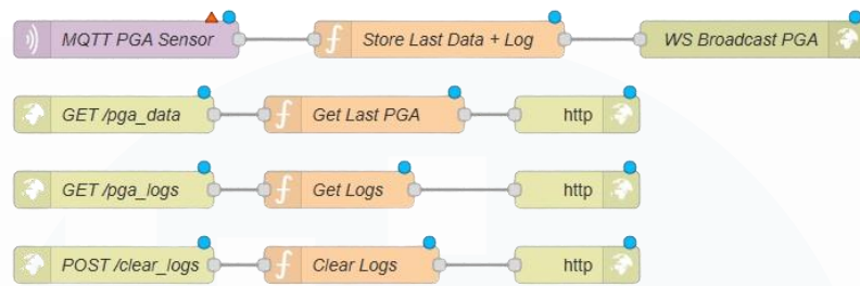
Gambar 3. 10 Diagram Flow Sistem Monitoring data PGA pada Node-RED
