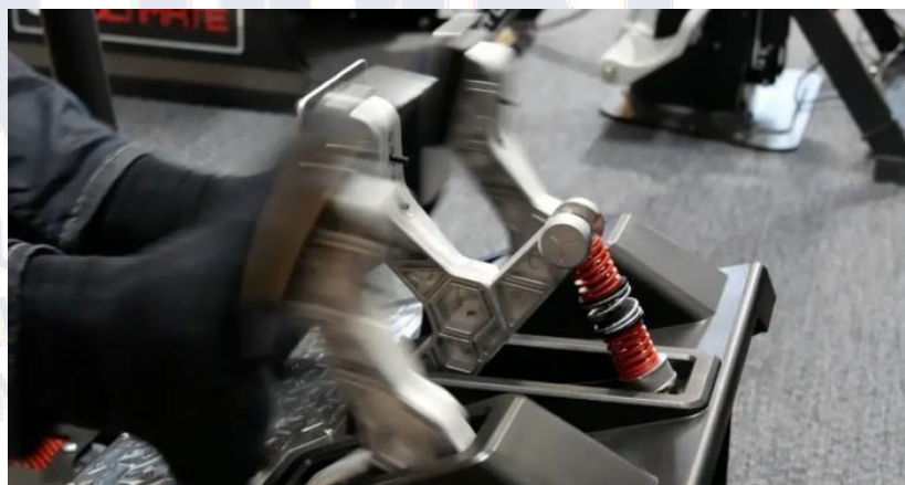
Gambar 2.21 Gas Pedal dengan Sensor Load Cell
