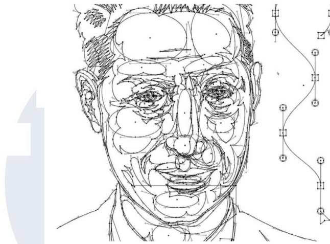
Gambar 2.10 Hasil Desain Vektor menggunakan Bezier Curve
