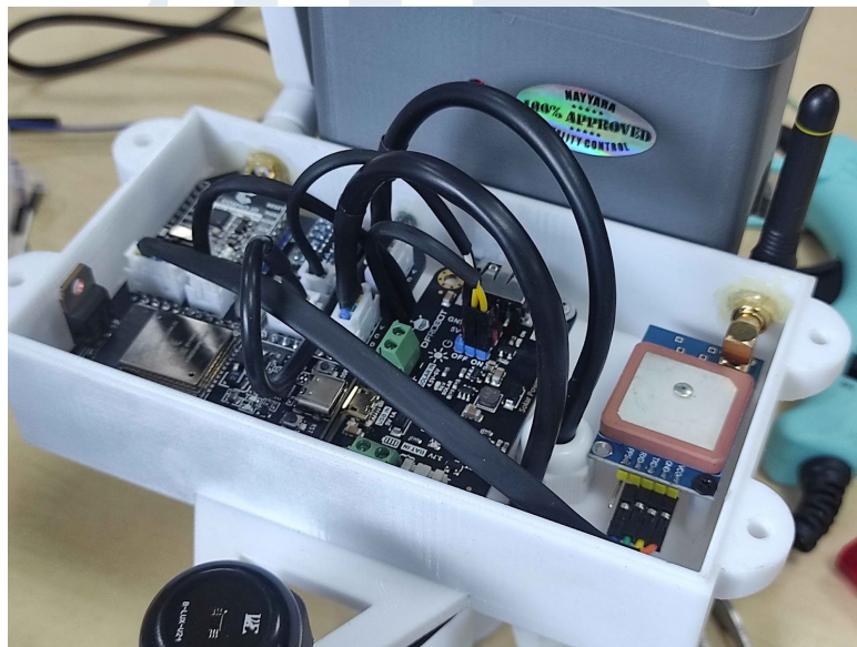
Gambar 1.1 Node IoT MySalak V1 yang menggunakan pre-built components
