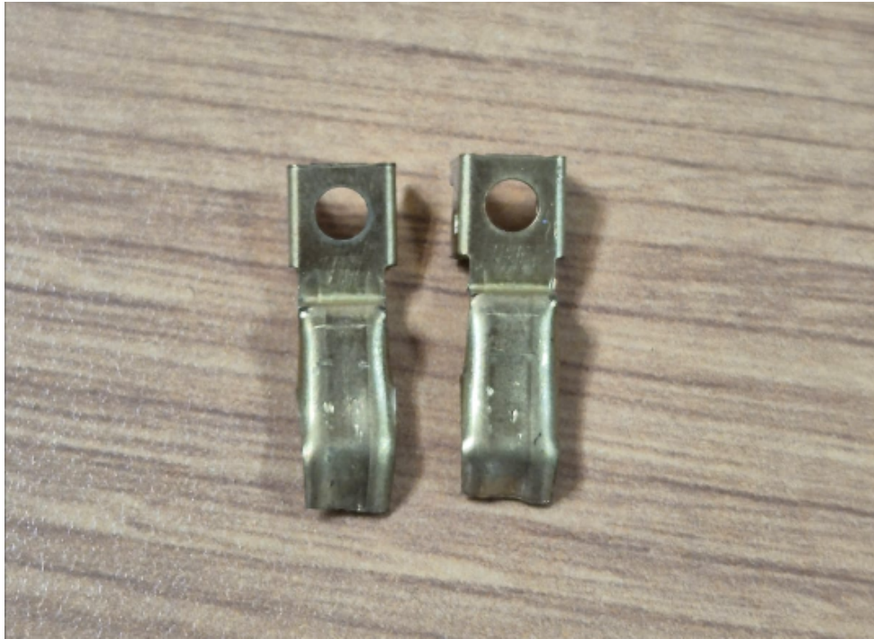
Gambar 3.21 Kontak female BROCO 344LN yang sudah di modifikasi
