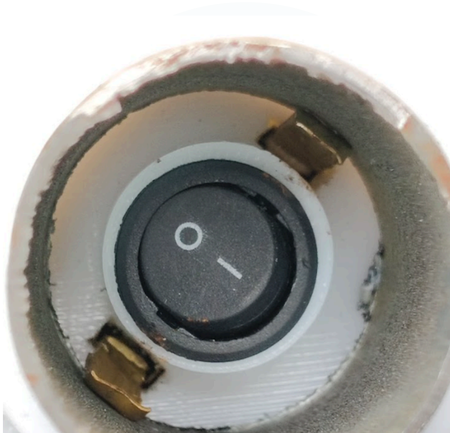
Gambar 3.19 Trigger pin ESP32 yang menyentuh pipa penopang
