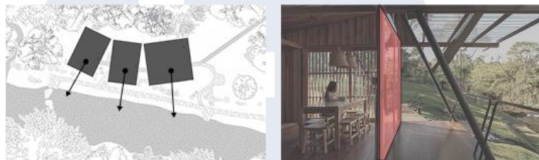
Gambar 2.16: Orientasi Bangunan Hoguera de Madera Refuge
