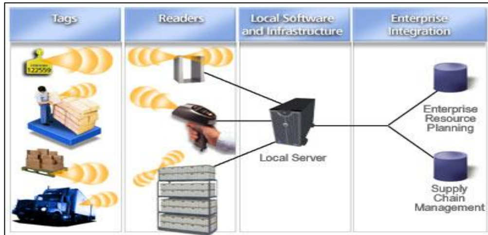
Gambar 2.1 Proses Pembacaan RFID[18]
